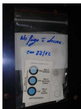
Pequeno ziploc, com papel de filtro impregnado e protegido com papel cristal; carta indicadora de humidade e dessecador
